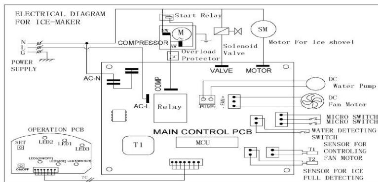
Start relay – реле запуска, Compressor – компрессор, Power supply – источник питания, Operation PCB – управление печатными платами, Main control
