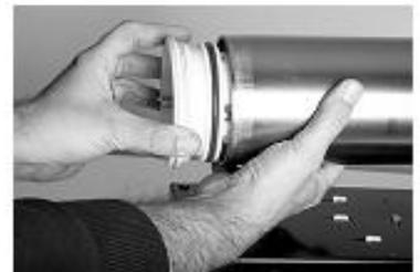
2. После этого, открутите винты, фиксирующие датчик температуры, расположенный внутри крышки. При необходимости вытащите вал привода – перемешивателя.
