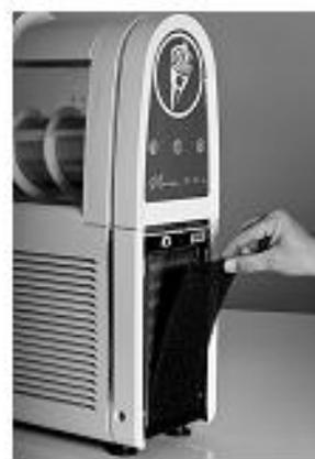
2. Открутите фиксирующие винты и снимите боковые панели.
